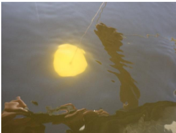
Figur 16. Siktdjup mäts med hjälp av en secchiskiva. En vit skiva sänks ner i vattnet tills den inte längre är synlig.
